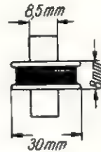
Rys. 2. Dławik 500 zwojów drutu 0,12 mm
